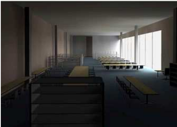
07 | BNCR, le simulazioni, effettuate con il programma Relux, hanno aiutato a valutare le prestazioni, in termini di comfort, dei sistemi di illuminazione naturale e artificiale BNCR, simulations, carried out with the software Relux helped to evaluate the performance, in terms of comfort, of the systems of natural and artificial lighting
